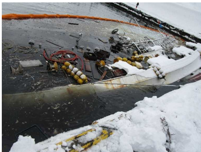
※船上の積雪により、転覆した漁船
